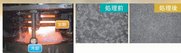
鋼を加熱して、炭素原子を鉄に固溶させます。その後急冷する事で炭素原子は拡散出来ず、過飽和になり鉄格子に歪みが出て硬化します。更に焼戻しをする事で粘さが加わります。弊社では炭素を浸入させて焼入れする浸炭焼入れと誘導加熱を利用してワークの表面自体を発熱させる高周波焼入れを主に行っています。
